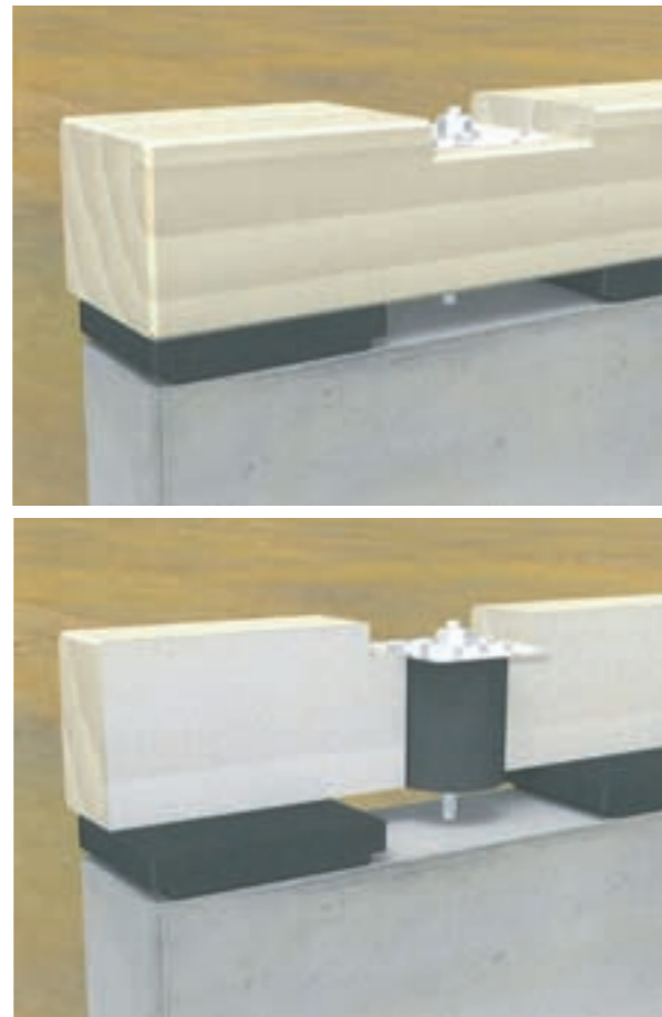
■減震工法(上：外観図 下：断面図)
